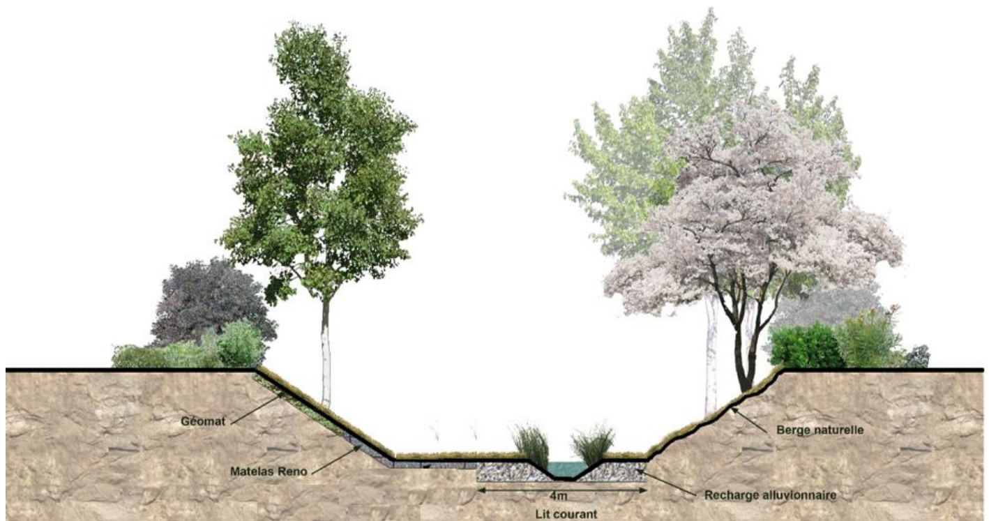
Figure 7 : Coupe type du lit du Rieumassel après réalisation du projet – Source : AVP
